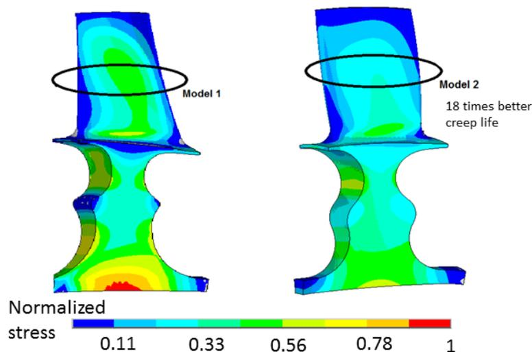
Figure 11. Rotor creep life estimation
